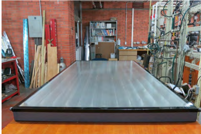
Figura 10. Prototipo de CPC desarrollado.
