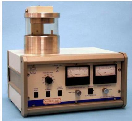
Figura 10. Sistema de pulverización catódica
