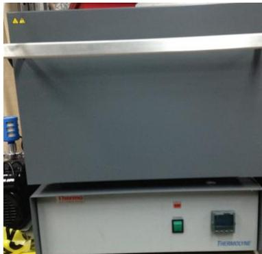
*Figura 12.* Horno que se utilizó para formar nanopartículas de oro.
