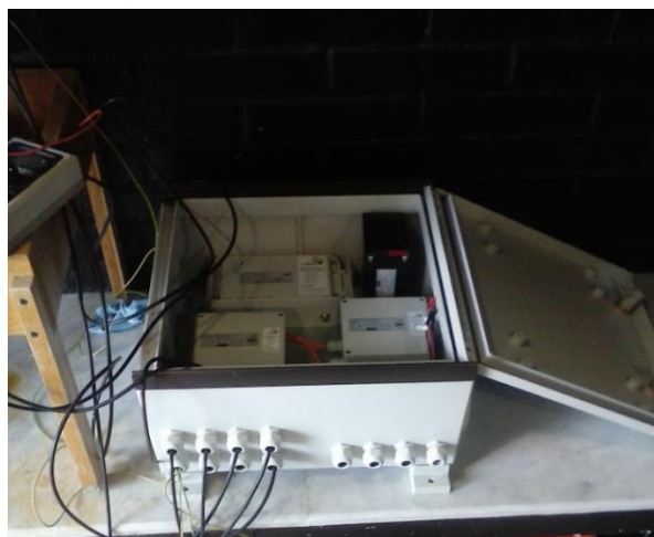
Figura 15. Equipo utilizado para la medición del potencial redox.
