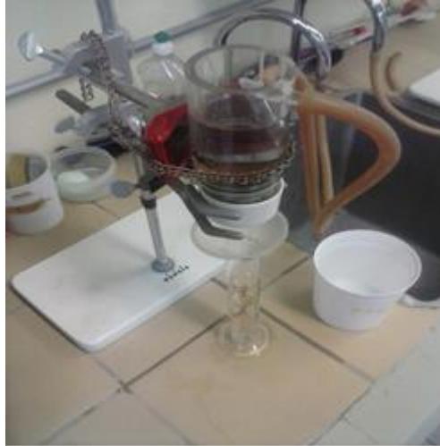
Figura 149. Análisis de conductividad hidráulica en muestras de suelo y sedimento.
