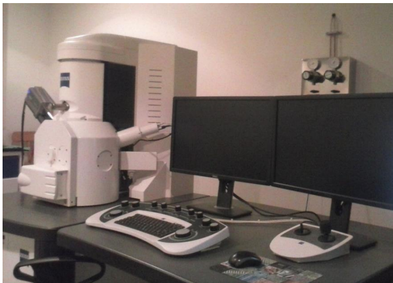
Figura 22. Microscopio Electrónico de Barrido utilizado para el análisis químico en secciones delgadas de suelos y sedimentos.
