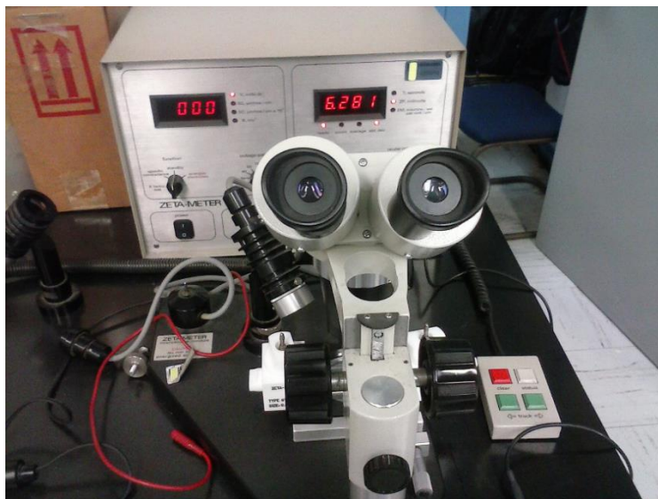
Figura 12. Equipo usado en la medición del potencial Z para la determinación del punto de carga cero (PZC).
