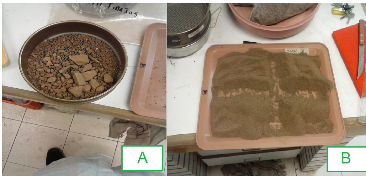
Figura 11. Imagen A. Tamizado de las muestras, en donde queda retenido el material grueso. Imagen B. Cuarteado de las muestras.
