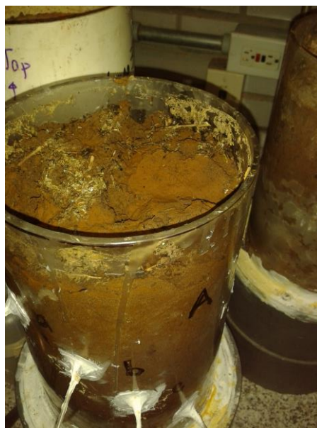
Figura 94. Cambios de coloración en la columna de suelo Bacanuchi después del tercer riego con la solución ácida ferrocuprífera.
