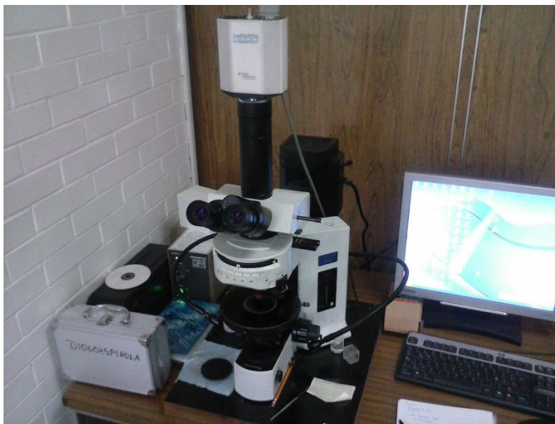
Figura 21. Microscopio petrográfico Olympus BX51 usado en los análisis micromorfológicos y morfométricos en las diversas secciones delgadas.
