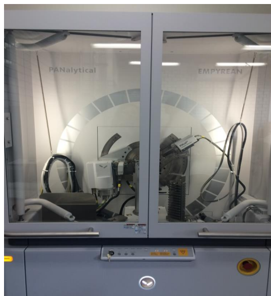
Figura 17. Difractómetro EMPYREAN en donde se realizó el análisis de DRX en las muestras de suelo y sedimento.
