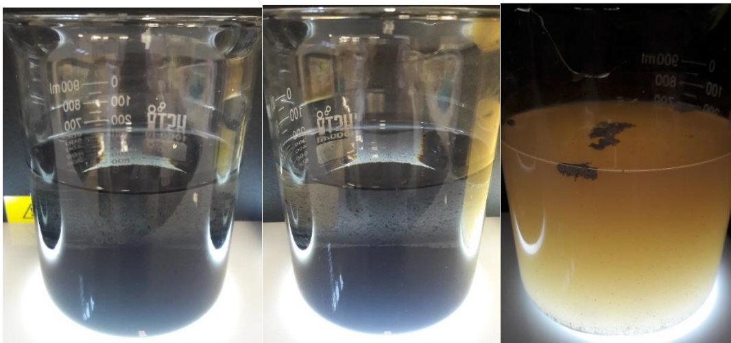
Figura 23b. Prueba 3 \text{Fe}_2(\text{SO}_4)_3 . Dosis: 535.7, 714.3 y 1785.7 mg/L
