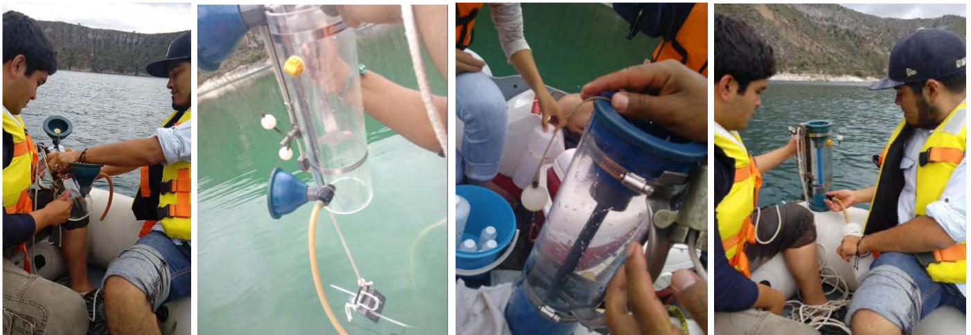
Fotos 16, 17, 18 y 19. Proceso de preparación de la incubación de productividad primaria por el método de botellas claras y oscuras.
