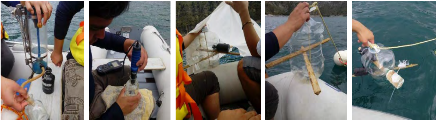
Fotos 11, 12, 13, 14 y 15. Proceso de toma de muestra con botella Van Dorn.
