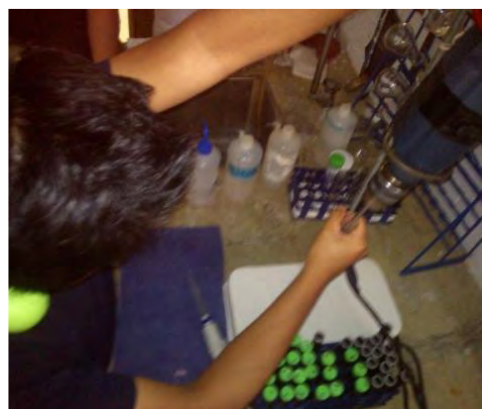
Fotos 25, 26, 27 y 28. Procedimiento de fluorimetría para determinación de clorofila "a", preparación de muestras para maceración de membranas, extracción del pigmento y lectura en fluorómetro.
