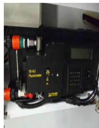
Fotos 25, 26, 27 y 28. Procedimiento de fluorimetría para determinación de clorofila "a", preparación de muestras para maceración de membranas, extracción del pigmento y lectura en fluorómetro.
