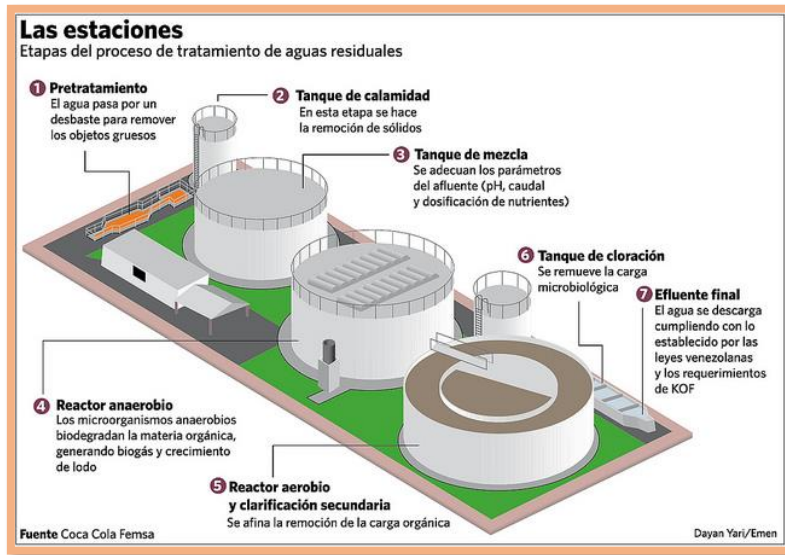
Ilustración 103: Etapas del proceso de tratamiento de aguas residuales (Google 2017)
