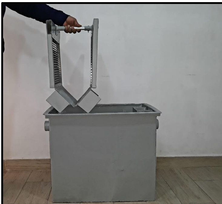
Figura 4.48 Salida del mecanismo del interior de la trampa de grasa
