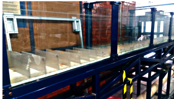
Figura 2.8: Fotografía del arreglo de obstáculos usados a lo largo del canal para generar el perfil de velocidades.
