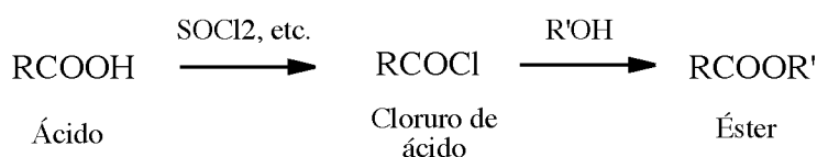
Figura 5.2. Ácido carboxílico a éster mediante cloruro de ácido [45]
