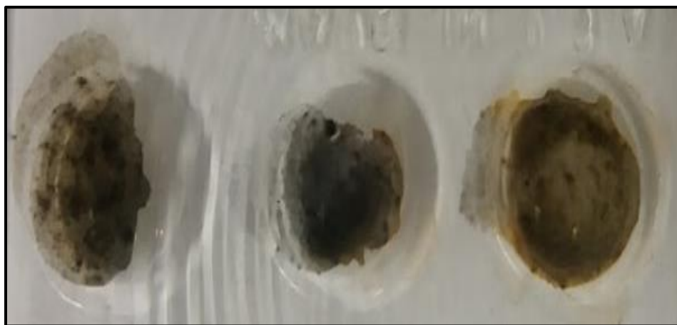
Figura 5. Imagen de la prueba de identificación de azúcares, el color azul indica la presencia de azúcares en la muestra. El color azul se puede apreciar en la muestra que se encuentra en la posición central de la figura.
