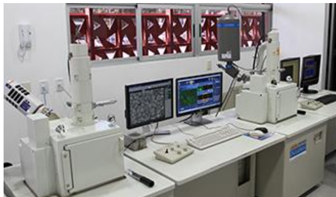
Figura 9. Microscopio Electrónico de Barrido multifuncional JEOL JSM-5900-LV, resolución: 0.3 nm (SEI) HV / 0.5nm (BEI) LV, amplificación: 18x - 300000x. [22]
