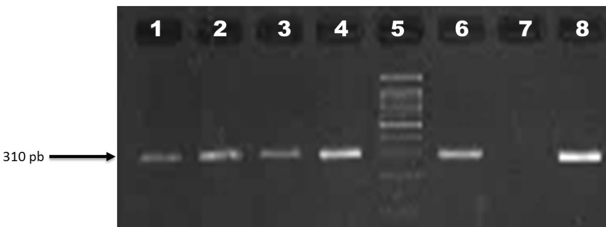
Fotografía 18. Detección por PCR convencional del gen mecA en S. aureus . Carriles 1-4 y 6, mecA (amplicón de 310 pb) en cepas de S. aureus aisladas de pacientes con infección periodontal; Carril 5, MWM (100pb); Carril 7, control negativo ( S. aureus ATCC 25923 mecA -); Carril 8, control positivo ( S. aureus ATCC 33592 mecA +).
