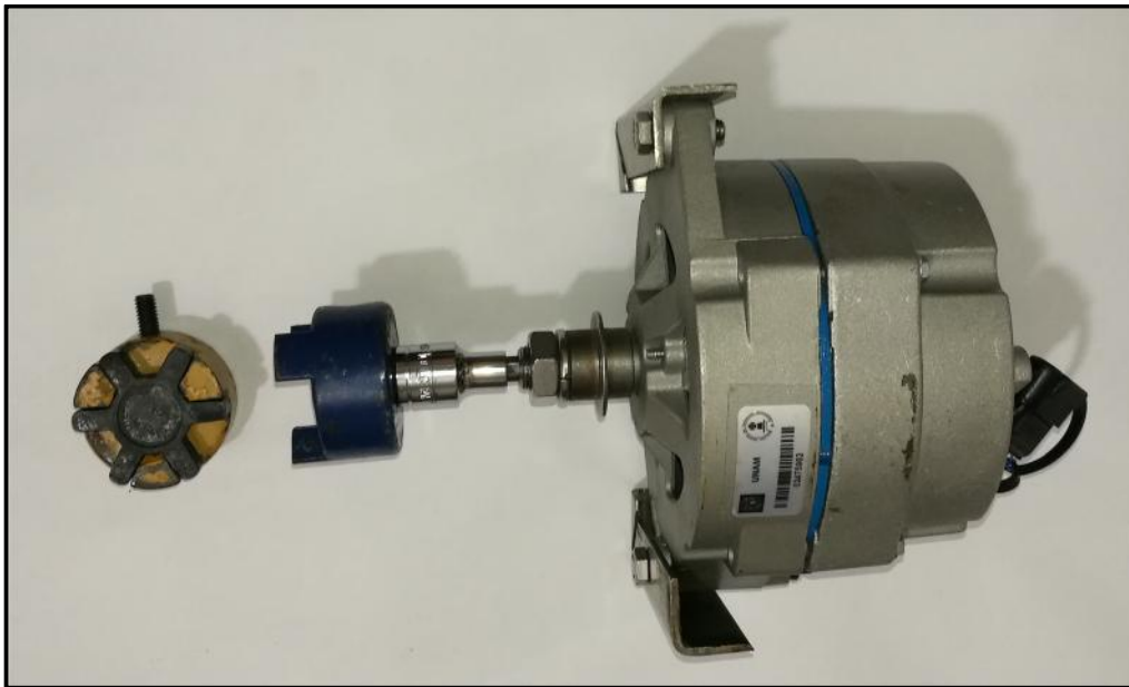
Figura 4.13 Acoplamiento instalado en eje de alternador
