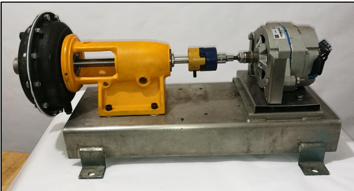
Figura 4.16 Armado final de la turbina
