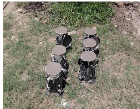
Imagen No.110.- Nota de remisión del suministro del concreto (características), prueba de revenimiento, temperatura del concreto y muestras o especímenes (cilíndricos de ensaye) del concreto, para un buen control de las estructuras coladas en obra.
