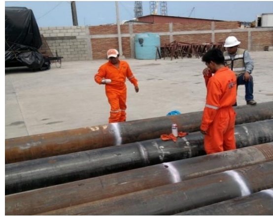
Imagen No.41.- Prueba de líquidos penetrantes en cordones de soldadura en la unión de pilotes.
