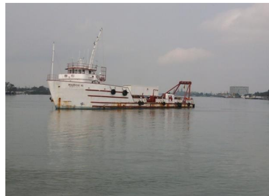
Imagen No.165.-Buque con viga de acero realizando rastrillado, dando varias pasadas frente al muelle del buque Justo Sierra, para dar nivelación en el canal de navegación interior del río Tuxpan.
