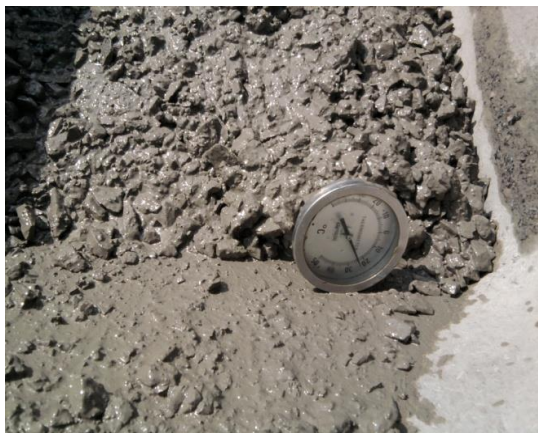
Imagen No.110.- Nota de remisión del suministro del concreto (características), prueba de revenimiento, temperatura del concreto y muestras o especímenes (cilíndricos de ensaye) del concreto, para un buen control de las estructuras coladas en obra.
