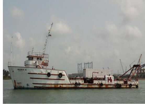
Imagen No.164.-Viga de acero de 15 m de longitud y buque, para nivelación del fondo marino, en el canal de navegación río Tuxpan.
