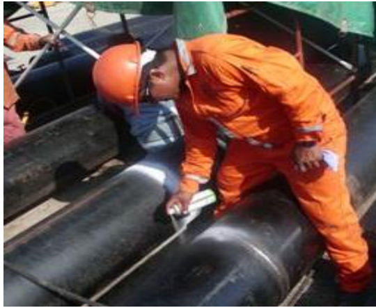
Imagen No.41.- Prueba de líquidos penetrantes en cordones de soldadura en la unión de pilotes.
