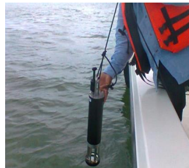
TOMA DE LECTURA VELOCIDAD DE SONIDO EN EL AGUA
