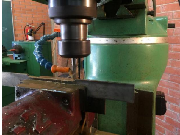
Figura 15. Maquinado con Fresadora Convencional
