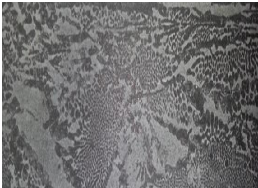
Figura 2. Microestructura de una fundición blanca hipereutéctica. Se observan importantes masas blancas de Cementita hipereutéctica. También se observan agrupaciones seudoeutéticas Ledeburita que están constituidas por pequeñas partículas negras de perlita sobre un fondo blanco de Cementita.
