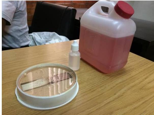
Figura 17. Unión de probeta con resina
