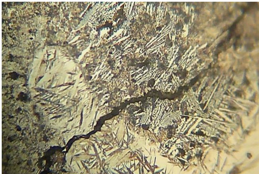
Figura 35. Presencia de tres cristales y grieta con grafito en su interior a un aumento de 400X.
