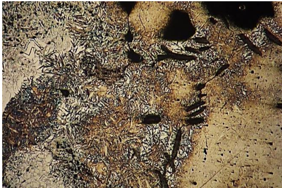
Figura 28. Línea de fusión y zona afectada por el calor a un aumento de 50X.
