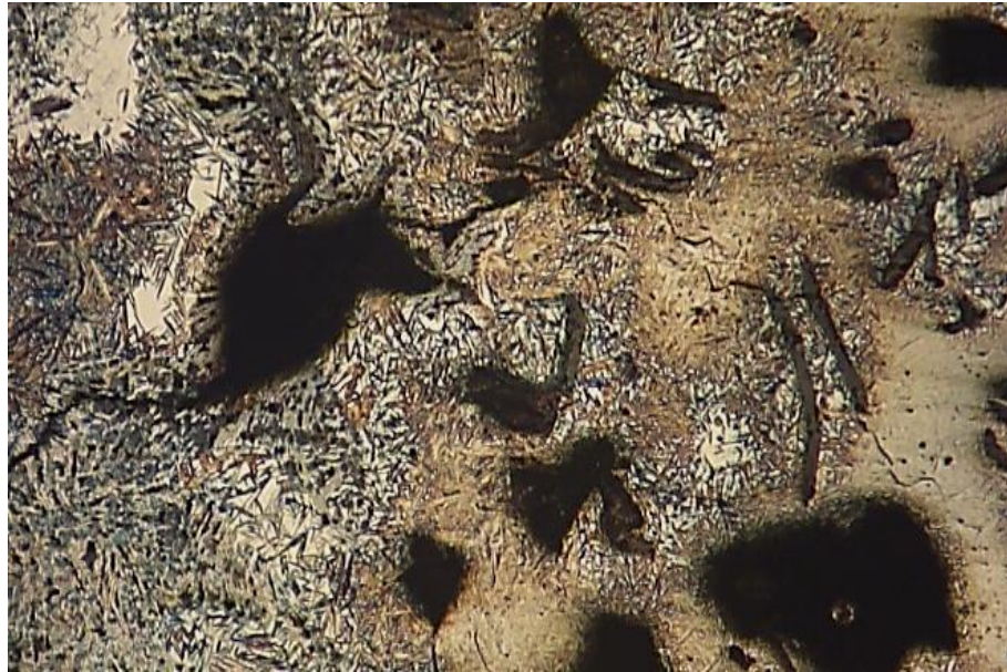
Figura 27. Línea de fusión y zona afectada por el calor a un aumento de 50X.
