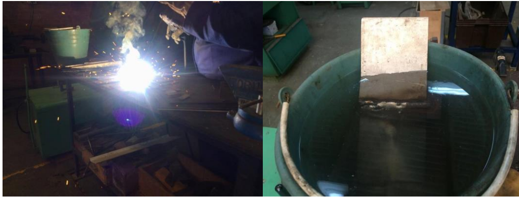
Figura 12. Soldadura y enfriamiento brusco de la placa
