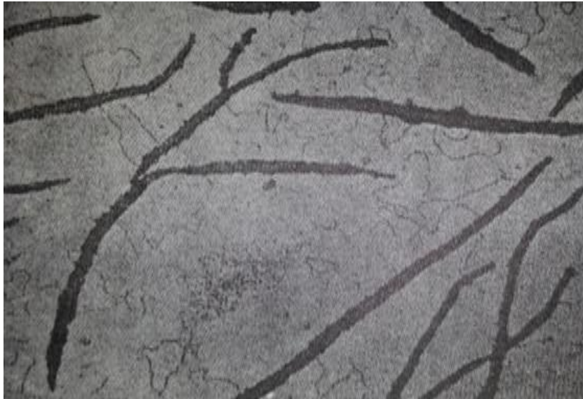
Figura 3. Fundición gris ferrítica. Láminas de grafito sobre un fondo blanco de cristales de Ferrita. 200X
