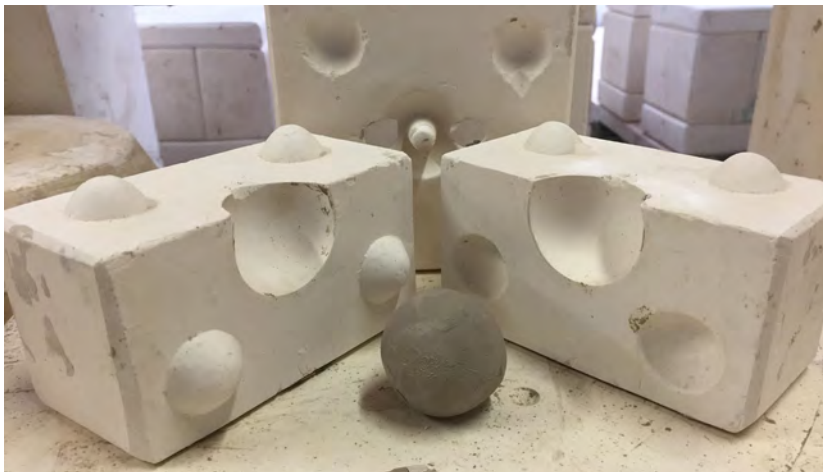
Molde de 3 piezas con un vertedero y un respiradero.
