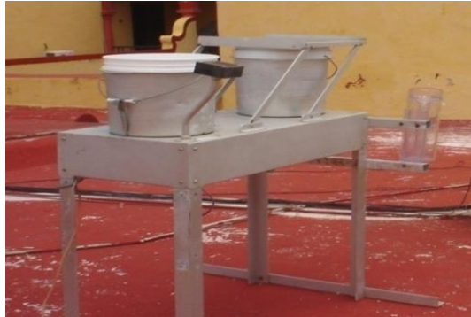
Figura 4. 1 Dispositivo de muestreo automático de precipitación húmeda y seca. Colector de precipitación húmeda y seca (Aerochem Metrics modelo 301). Fuente: Torres, 2009.
