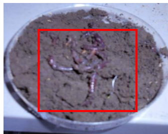
Figura 6.29 Con una muestra de Pb(NO_3)_2 a 500 mg/kg con todos los organismos vivos en una coloración brillante.
