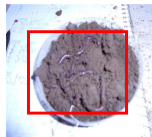
Figura 6. 30 Muestra de \text{NaAsO}_2 a 50 mg/kg y 1000 mg/kg de \text{Pb}(\text{NO}_3)_2 con 4 organismos muertos.
