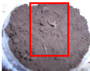
Figura 6.21 Con una muestra de \text{NaAsO}_2 a 400 mg/kg. Se presentaron 5 organismos enroscados y muertos.
