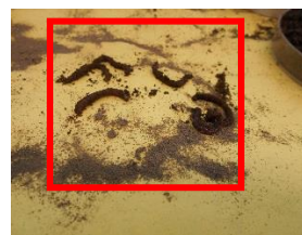
Figura 6.22 Con una muestra de \text{NaAsO}_2 a 300mg/kg. Se presentaron 4 organismos muertos fuera de la muestra de suelo artificial al ser extraídos manualmente.
