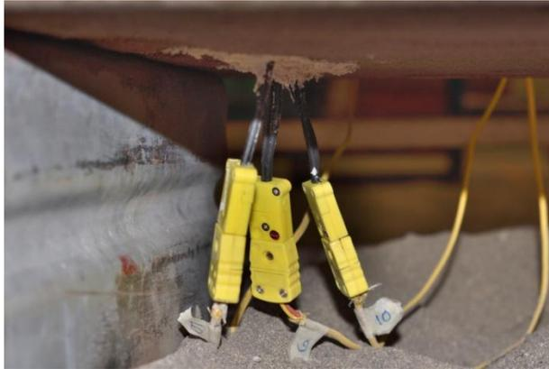
**Figura 23.** Fotografía de los termopares por la parte inferior del molde.
