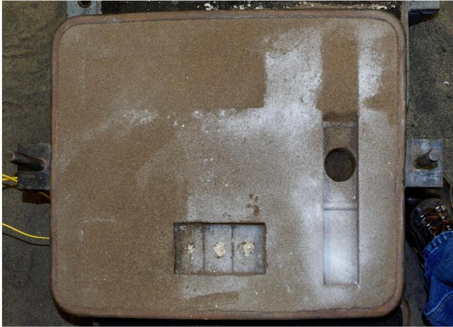
**Figura 21. Molde terminando de los escalones.**
