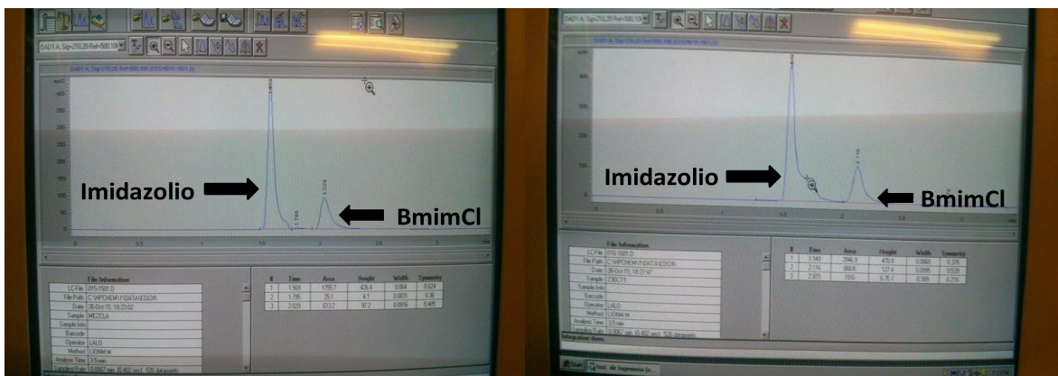
Figura 6.5. Comparación entre un estándar con un imidazolio y BmimCl (izquierda) y una muestra del reactor del 23 de octubre (derecha).
