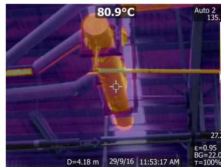
Ilustración 24 Termografía del aislante
