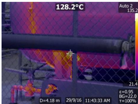
Ilustración 20 Aumento de temperatura en los soportes
