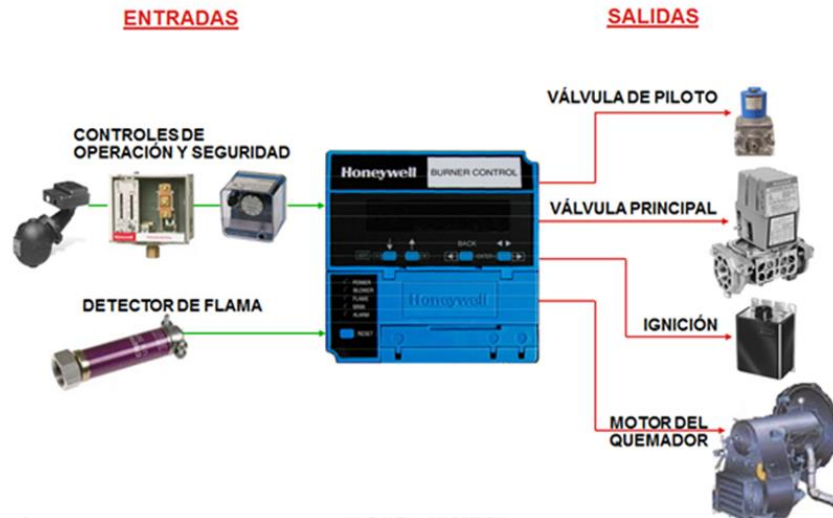
Ilustración 31 de Seguridad de Llama y relación Aire/Combustión
