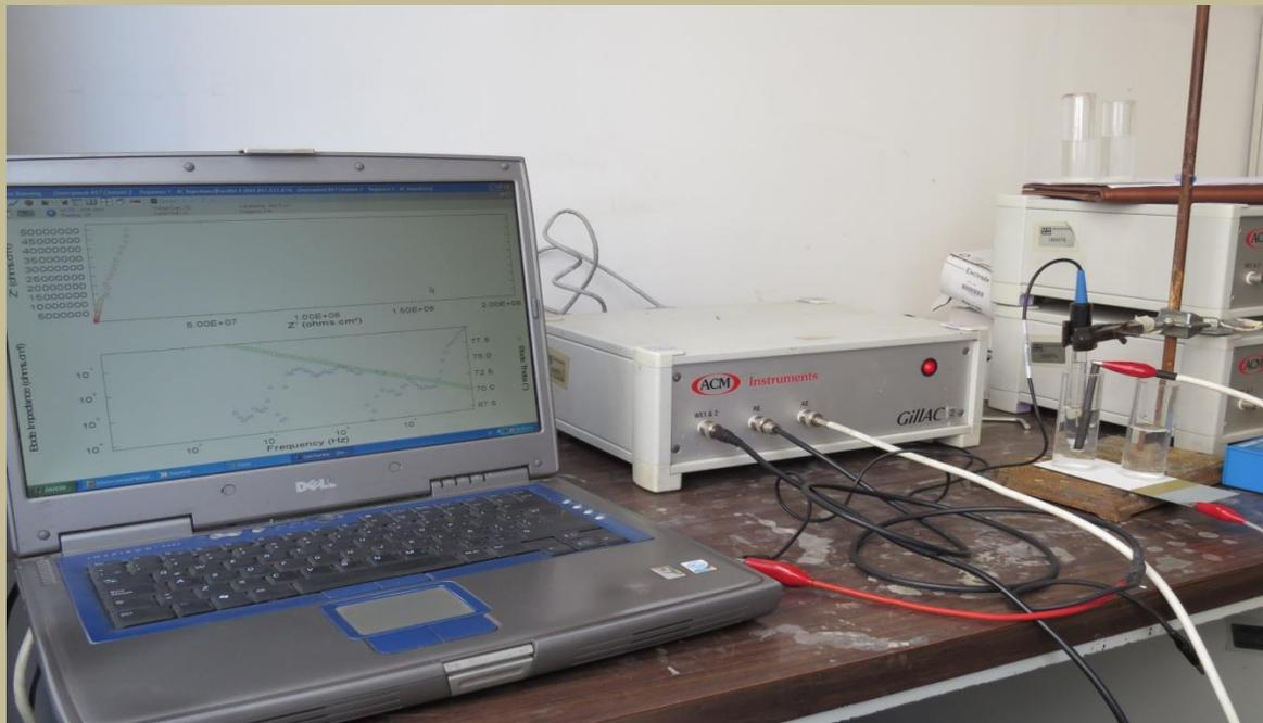
**Figura 2.10 Conexión del equipo de medición Gill y celda a equipo de cómputo.**
