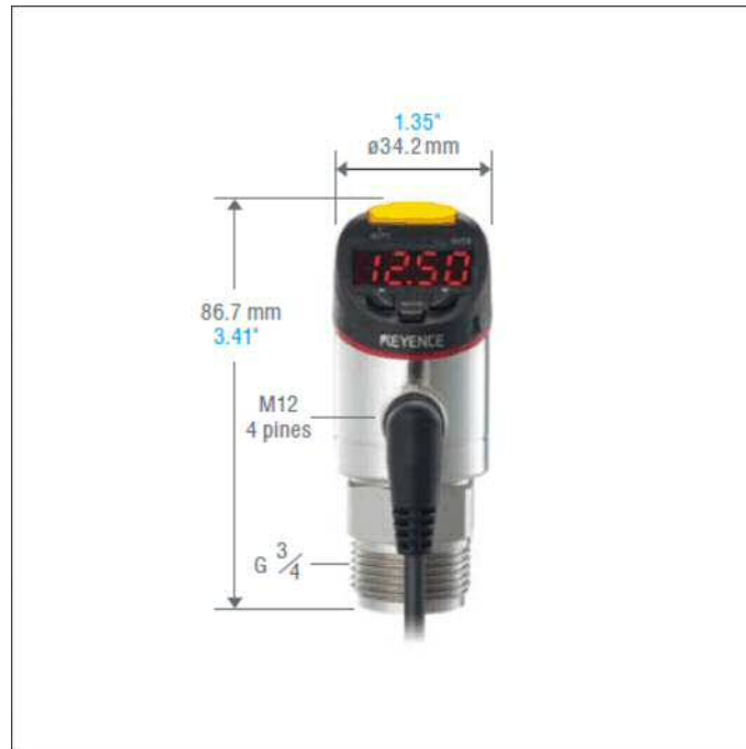
Figura 3.1: Sensor de presión Keyence GP-025. [2]
