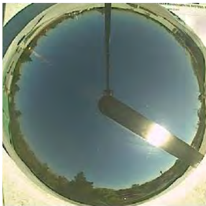
Figura 5.1: Fotografía de la cámara de nubosidad, 17/02/2014, altura solar: 38.06°, ubicada en la “Plataforma de observación de luz natural”, la cual muestra un cielo mayormente despejado.
