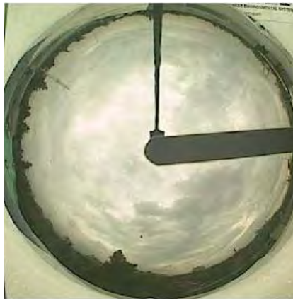
Figura 5.7: Fotografía de la cámara de nubosidad, 07/08/2014, altura solar: 63.57^\circ , ubicada en la “Plataforma de observación de luz natural”, la cual muestra un cielo nublado denso.
