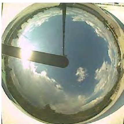
Figura 5.5: Fotografía de la cámara de nubosidad, 20/07/2014, altura solar: 35.54°, ubicada en la “Plataforma de observación de luz natural”, la cual muestra un cielo parcialmente nublado.
