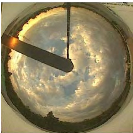
Figura 5.4: Fotografía de la cámara de nubosidad, 12/06/2014, altura solar: 3.71^\circ , ubicada en la “Plataforma de observación de luz natural”, la cual muestra un cielo parcialmente nublado con nubes de ligeras a densas.
