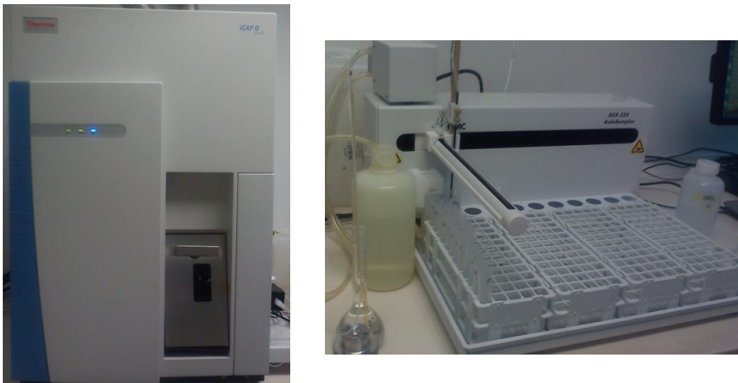
Figura 3.7. Equipo de espectroscopía de emisión atómica con acoplamiento inductivo de plasma con detector de masas ( ICP-MS , en inglés) marca Thermo Scientific y su automuestreador ASX 520 del Instituto de Geofísica, UNAM
