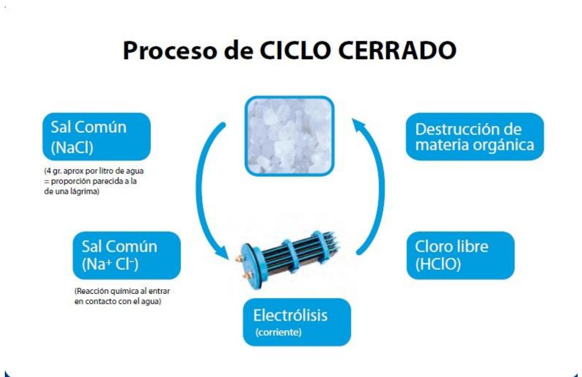
Figura 14 "Sistema de cloración"
