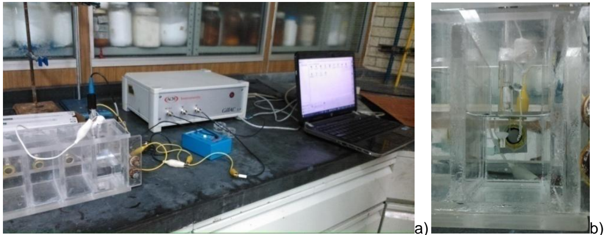
Figura 3.4. Prueba de ruido electroquímico empleada en este trabajo a) Equipo empleado en la prueba de ruido electroquímico, b) Arreglo de la celda mostrando el electrodo de trabajo (acero 304L), un contraelectrodo de platino (Pt) y el electrodo de referencia (Ag/AgCl).
