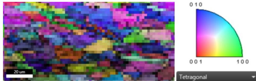
Figura 2.9. Orientación cristalográfica de un acero inoxidable 304L sin deformación, imágenes IPF+IQ sobrepuestas.
