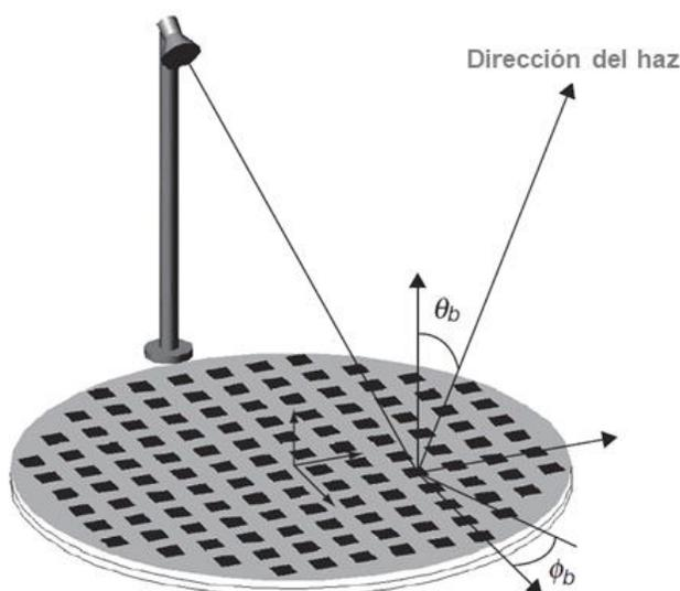
Figura 1.2 Geometría y sistema de coordenadas de un arreglo reflectivo
