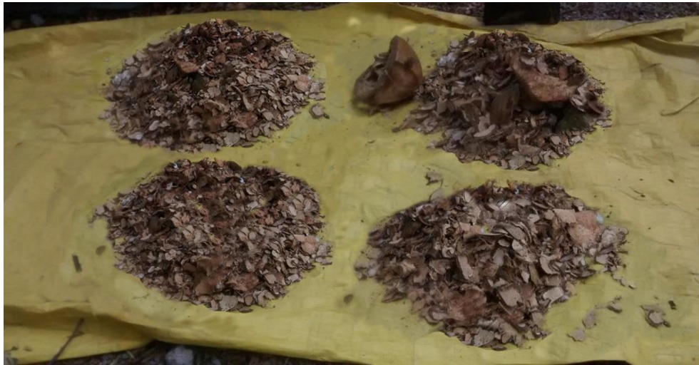
Figura 5.5 Método de cuarteo con residuos de cáscara de coco
