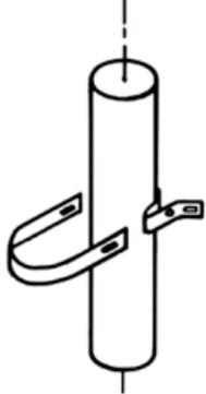
Sin empaque, por lo tanto permite el libre deslizamiento de la tubería. La abrazadera corrediza se utiliza después de un cambio de dirección seguido por un tramo largo de tubería (20 diámetros o más).
