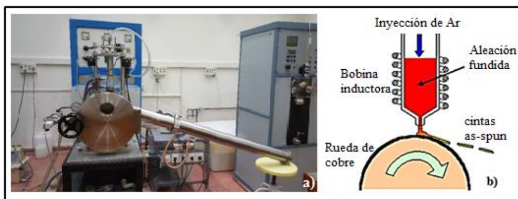
Fig. 3.5. a) Equipo melt-spinner y b) esquema del procesamiento del material a través de melt-spinning .
