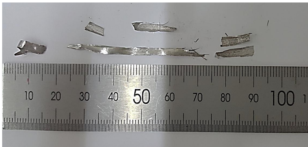
Fig. 3.6. Fragmentos de cinta pertenecientes a la aleación MnBi obtenidos mediante solidificación ultra rápida.
