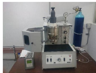
Fig. 3.2. Horno de arco eléctrico.
