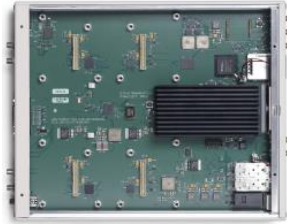
Figura 3.14. Vista superior interna del USRP X300 [3].
