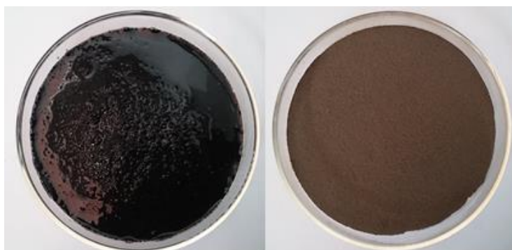
Figura 5.1 Lodo granular anaerobio antes y después del tratamiento térmico.
