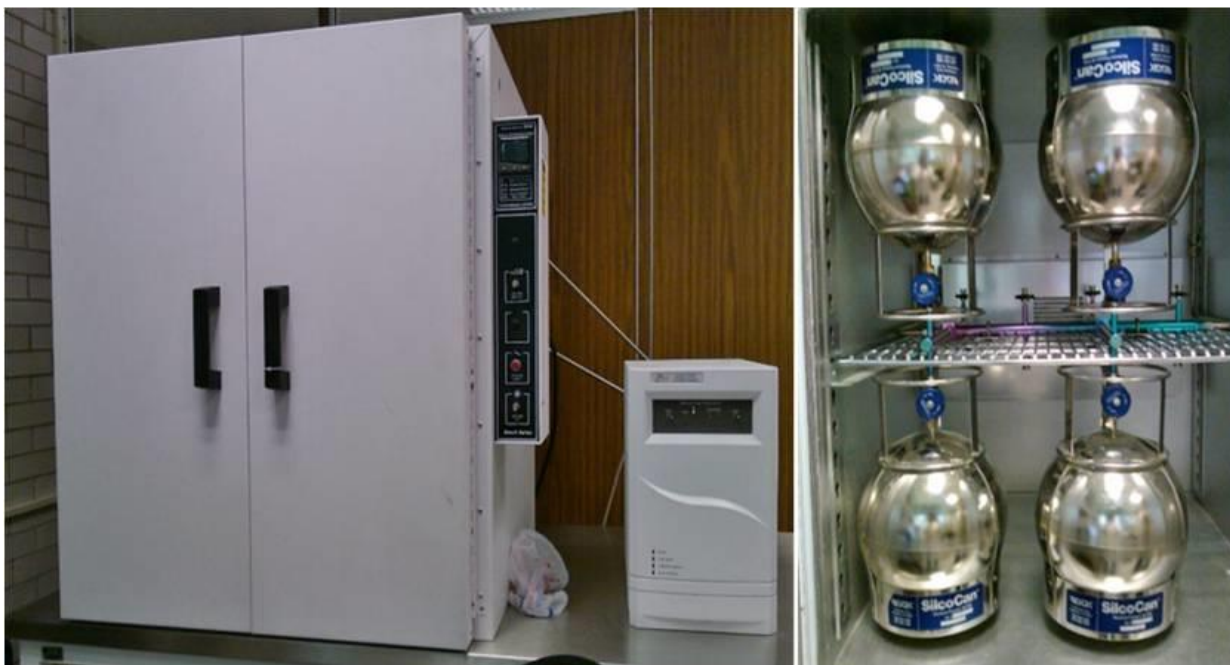
Figura 4.11: Sistema de limpieza de canister (Silco Can) marca ENTECH.
