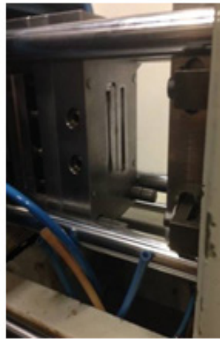
Máquina de inyección. Laboratorio de Procesos de Molde de probetas normalizado fabricación de materiales.
