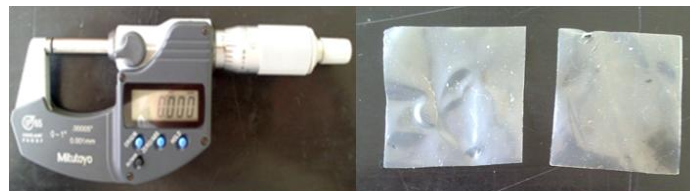
Figura 25. Micrómetro digital y porciones de película.
