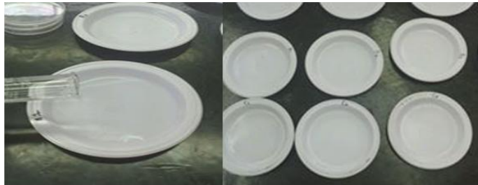
Figura 14. Secado de películas comestibles a base de grenetina.
