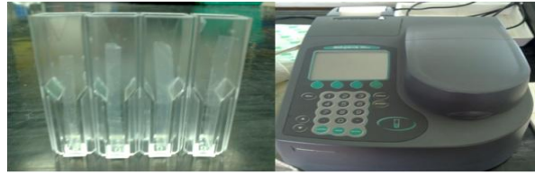
Figura 26. Porción rectangular de la película en la parte frontal de la celda y equipo de medición.
