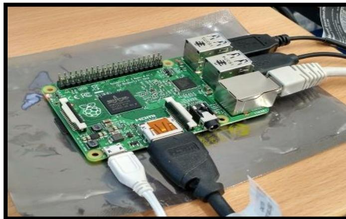
*Ilustración 3.5 Conexiones de la Raspberry Pi 2.<sup>21</sup>*
