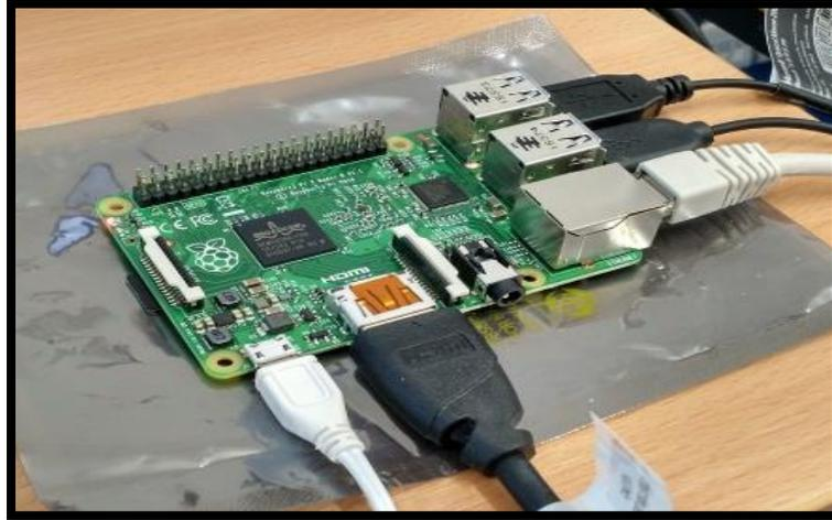
Ilustración I.20 Conexiones de la Raspberry Pi 2.<sup>57</sup>
