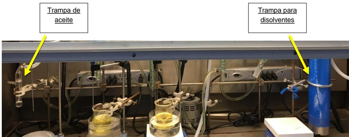
**Imagen 3.** Línea doble de vacío/nitrógeno con trampa de aceite y trampa fría para condensar disolventes.
