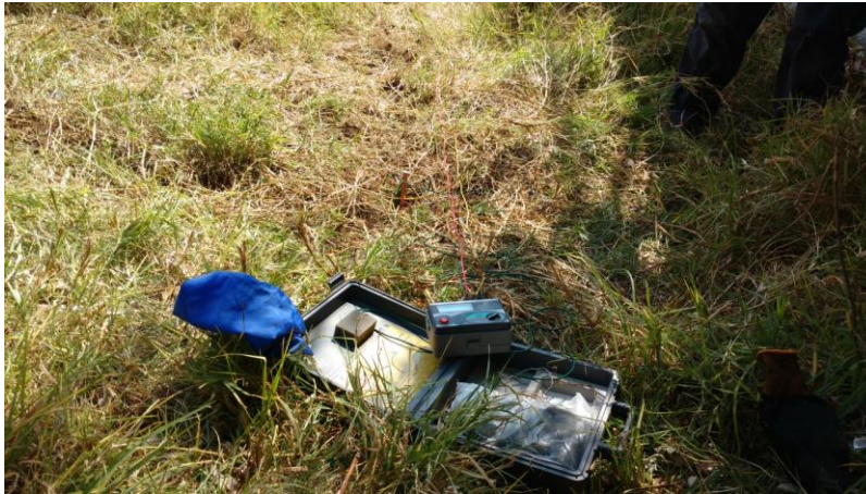
Figura 4.11. Equipo de medición digital de tierra KYORITSU, modelo 4105A.
