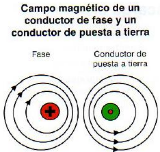
Figura 2.2 Campo magnético en dos conductores [6] .
