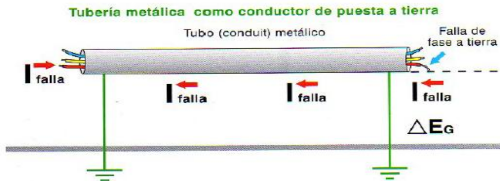
Figura 2.3 Tubería metálica utilizada como conductor de puesta a tierra [6] .
