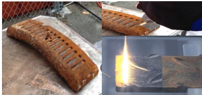
Fig. 12. Eliminación de óxido impactando laser al material corroído. (Anónimo, 2016)
