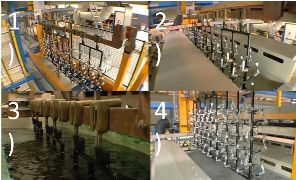
Fig. 20 Proceso en bastidor : 1) Bastidores , 2) Colocación de bastidor en baño , 3) Bastidor en baño eletrolitico, 4) Producto final en bastidor. (Industrias Goini, 2013)
