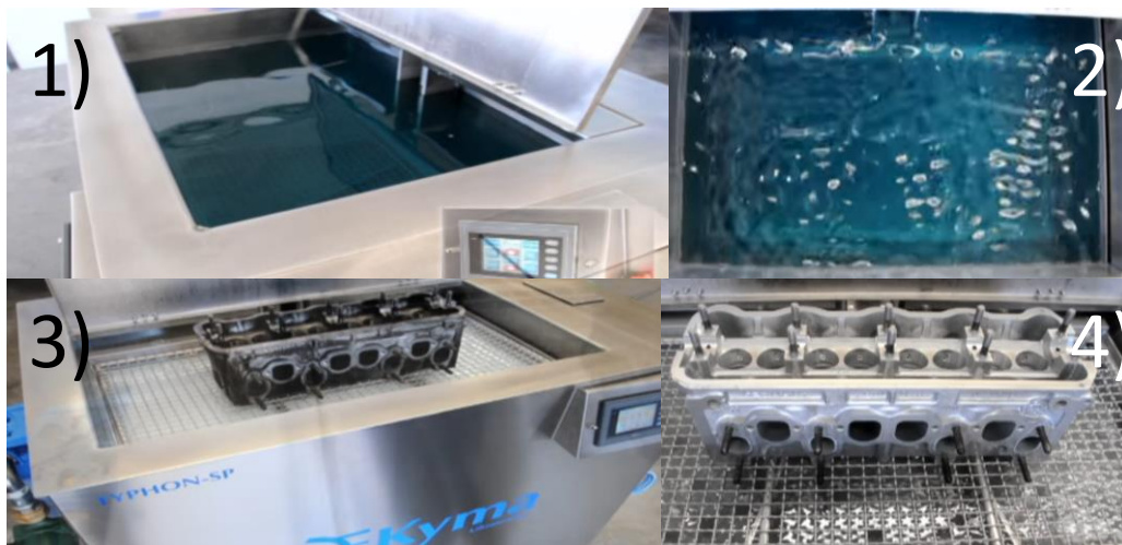
Fig. 22 Limpieza con agitador ultrasonico (Ekyma Ultrasonidos, 2017)
