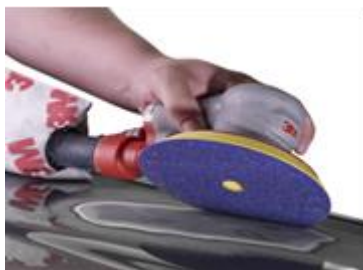
Fig. 3. Discos Hookit 260I * 10, Lijadora roto portátil neumática, aspiración central con bolsa recolectora de polvo.
