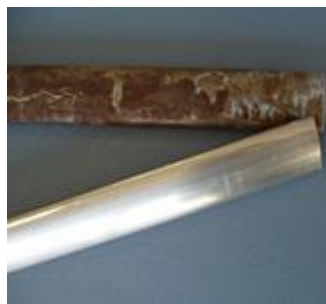
Fig. 9. Antes y después del decapado químico SIMET
