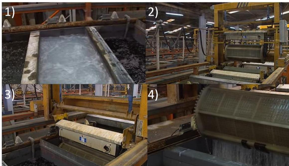
Fig. 19 Proceso en barril: 1) Soluciones para las etapas de electrodeposición de metales , 2) Barril perforado , 3) inmersión de barril perforado, 4) Emerger el barril de la última etapa. (Femeval Valencia , 2010)
