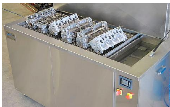
Fig. 13. Equipo de ultrasonido para desengrase (Industry, 2017).
