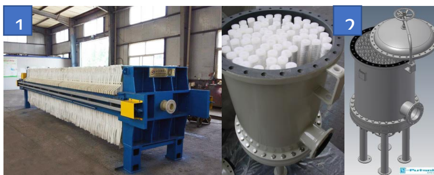
Fig. 23 Filtros: 1)Placas (Innovation Huayi, 2017) y 2) cartucho (Putsch Nerva S.A , 2017)
