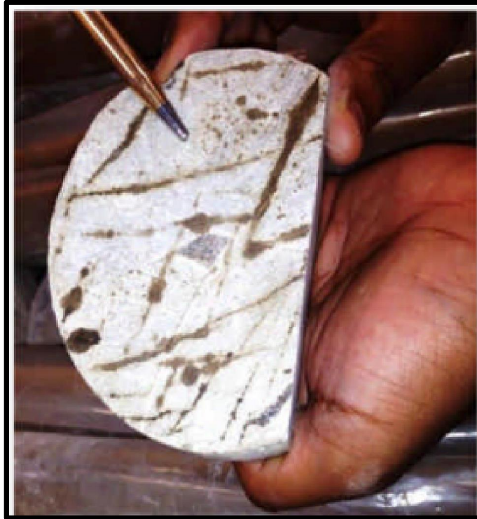
Figura 2.7 Muestra de núcleo mostrando fracturas naturales con contenido de aceite. "Vassilellis and Jones (2004), Core sample showing oil filled natural fractures, [Figura], Recuperado del paper SPE-178634".
