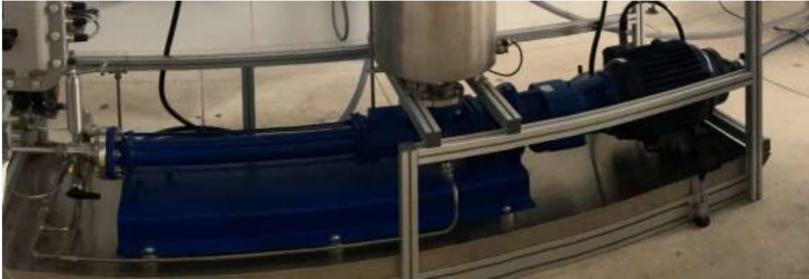
Figura 5.9 Bomba de Cavidad Progresiva del equipo friction loop 6500.
