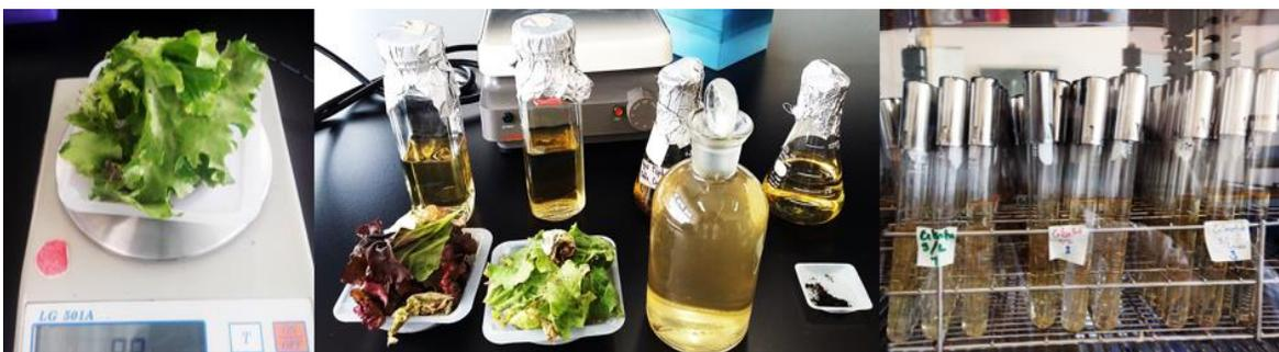
**Figura 8. Procesamiento de muestras y siembra en tubos de dilución con agua peptonada.**
