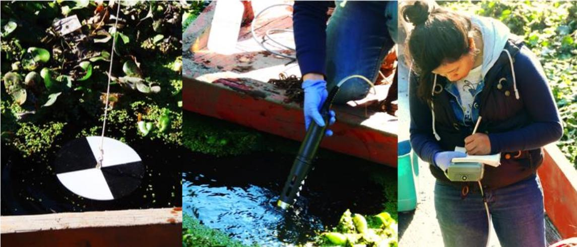
**Figura 4. Registro de transparencia y profundidad con el disco de Secchi y registro de los parámetros físico-químicos con el multiparámetros en agua.**
