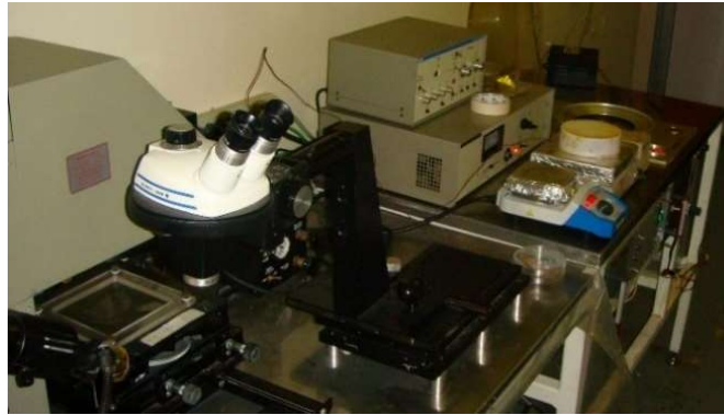
Figura 2.12. Equipo utilizado para el proceso de litografía. Podemos observar el spin-coating y la cámara de exposición a UV.
