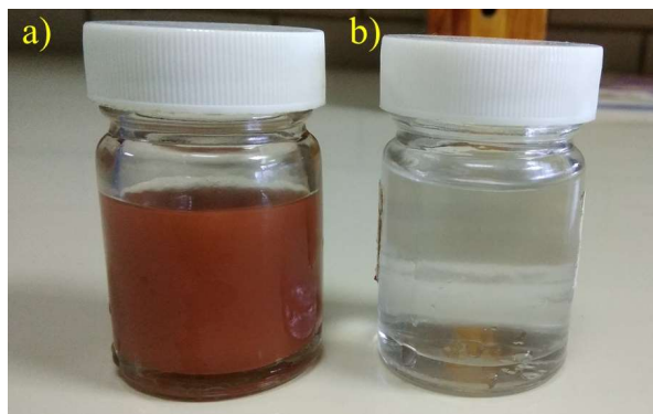
Figura 6.3. a) Suspensión de partículas de cobre junto con SDS. b) Suspensión de SDS.
