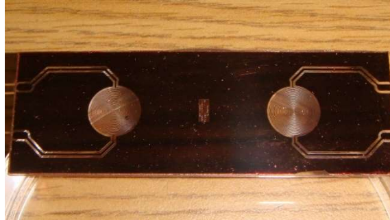
Figura 2.14. Sensor tipo espiral depositado sobre un sustrato de vidrio después del ataque con cloruro férrico.
