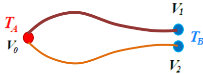
Figura 2.1 Representación esquemática de un termopar formado por dos conductores diferentes (líneas café y naranja). Basado en el efecto Seebeck, este termopar genera una diferencia de potencial entre los extremos 1 y 2, a partir de una diferencia de temperatura entre los puntos A y B.
