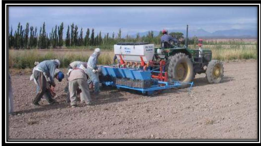
Figura 1.6 Corrección manual de una plantadora mecánica
