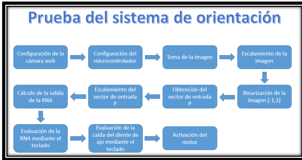
Figura 3.7 Diagrama de bloques del programa de prueba del sistema de orientación
