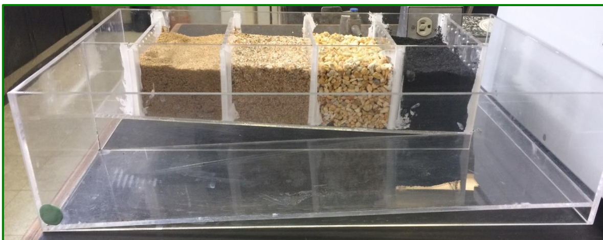
FOTOGRAFÍA 25 VISTA DE PERFIL DE FILTRO, SUSTRATOS Y DESNIVEL (FUENTE: AUTOR)
