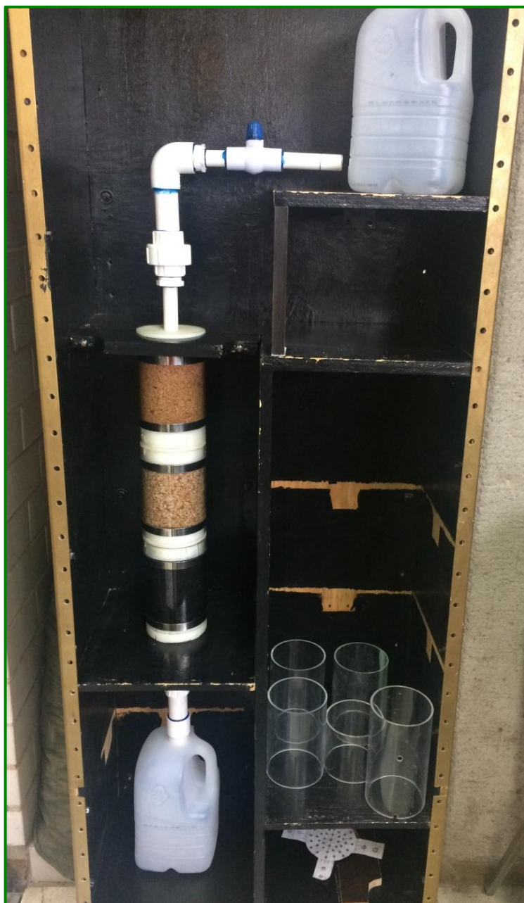
FOTOGRAFÍA 22 VISTA PRELIMINAR DEL FILTRO VERTICAL (FUENTE: AUTOR)
