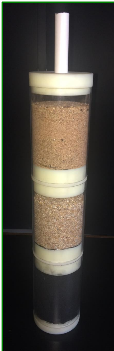
FOTOGRAFÍA 20 FILTRO VERTICAL (FUENTE: AUTOR)
