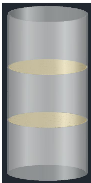
IMAGEN 2 DIAGRAMA 3D FILTRO CON MEMBRANA DE QUITOSANO
