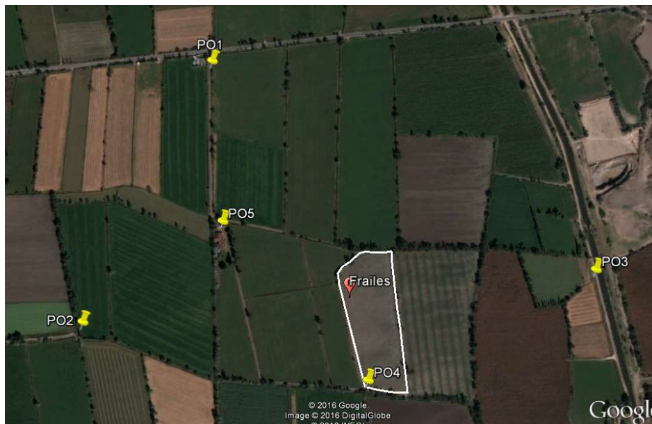
Figura 49. Localización de pozos de observación ya instalados (PO1, PO2 y PO3) y propuestos (PO4 y PO5); (imagen tomada de google).
