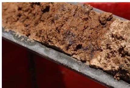
Figura 30. Fotografía de una sección de barrena que muestra las motas redox encontradas en el material extraído del pseudo-estrato con media a alta compactación.
