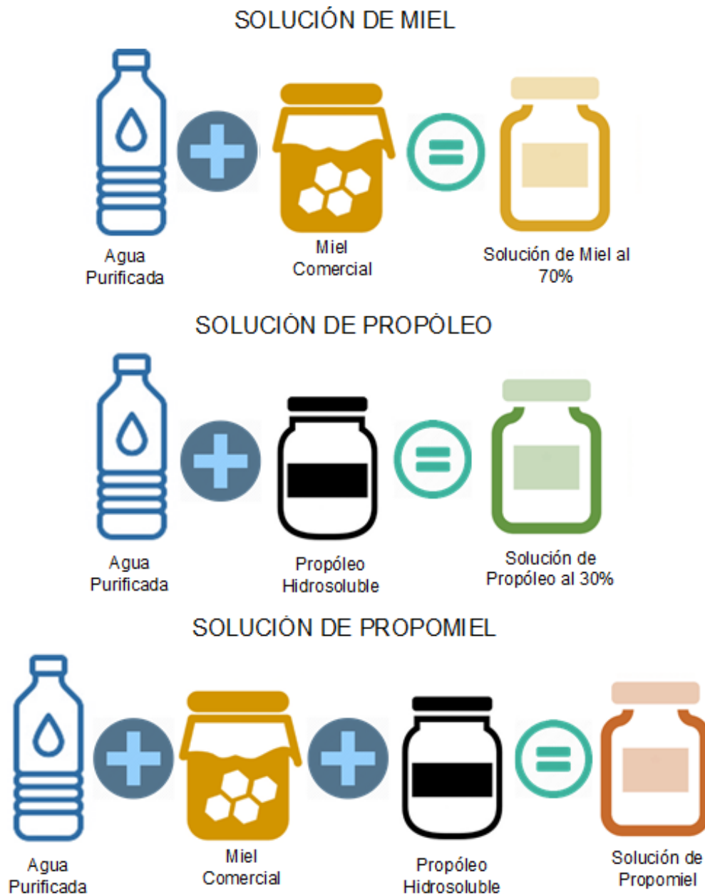
Figura 4. El esquema muestra cómo se realizaron las soluciones que se utilizaron durante la experimentación.
