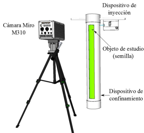
Figura 3.7: Montaje experimental utilizado.
